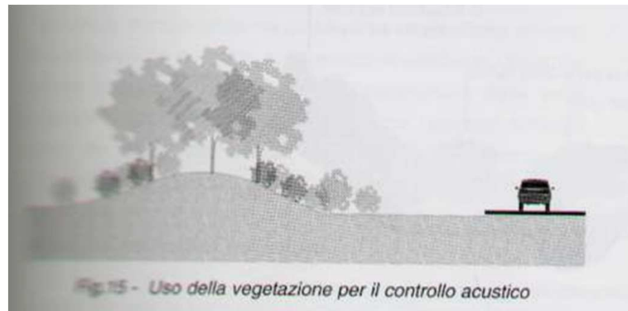
Fig. 38 - Esempio di barriera acustica vegetata per la protezione delle unità residenziali dal rumore del traffico.
